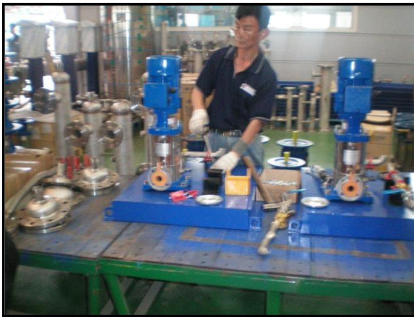
Хэрэгцээний усны насосуудын дотоод бүтэц, түүнийг угсрах үйл явц
