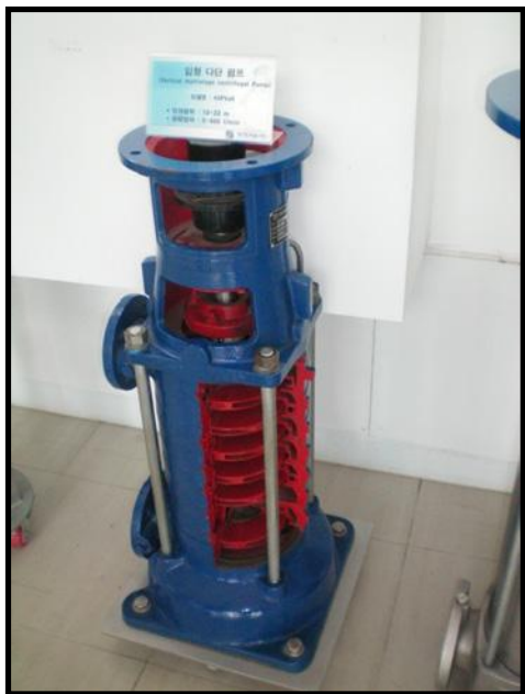
Хэрэгцээний усны насосуудын дотоод бүтэц, түүнийг угсрах үйл явц
