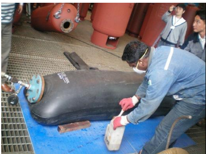
Тэлэлтийн бакны резин өрцийг ашиглалтанд туршиж, шалгаж байгаа нь:
