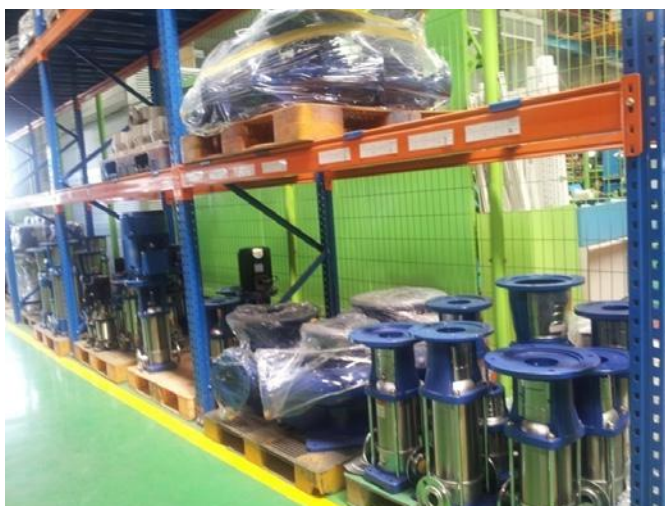
Тоног төхөөрөмжийн үйлдвэрт угсарсан олон шатлалт насосууд
