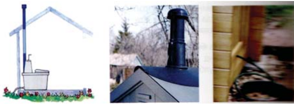
Зураг 6. Ялзмаг үүсгэх жорлон ба илүүдэл шингэн зайлууллт, агааржуулалт
