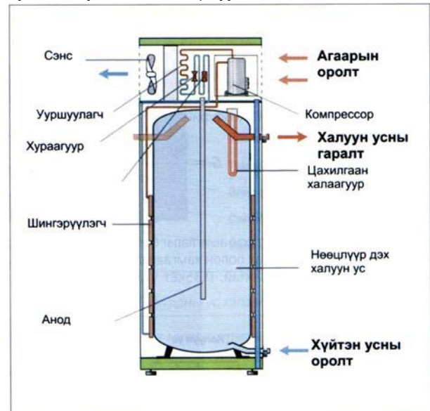
Зураг 8 Accelera 300 дулааны насосны бүтэц
