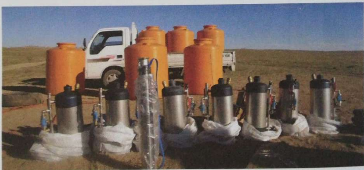
Жижиг суурин газар буюу цагт 1-1.5тонн ус цэвэршүүлэх төхөөрөмж
